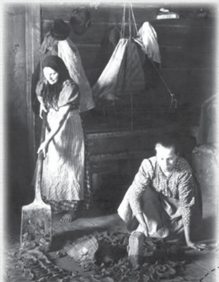
Процесс подготовки исходного сырья: разминание и перемешивание глины. Нач. XX в. Московская губ., Дмитровский уезд
