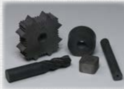
Керамический металлообрабатывающий инструмент для чистовой обработки стали и сплавов
