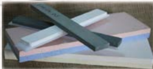
Абразивные бруски. Материал: элек- трокорунд, карбид кремния.
