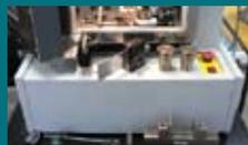
Универсальная испытательная машина с температурной камерой LLOYD Instruments LR5K
