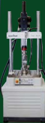
Сервогидравлическая усталостная машина Amsler HC10
